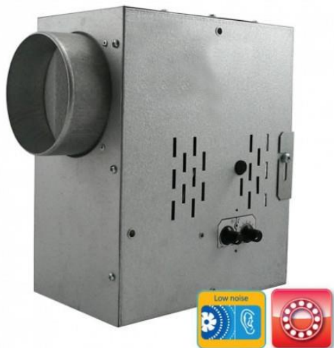
Rys. 58: Wentylator promieniowy z wytłumieniem, termostatem i regulacją obrotów, 850 m 3 , 29 dB, Dalap SPV 200 T.
