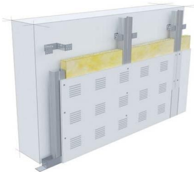
Rys. 11: Okładzina dźwiękochłonna kotwiona, wg schematu Nida Tynk CD/ES-12,5. Pokryciem jest jedna warstwa płyty perforowanej, która przepuszcza dźwięk.
